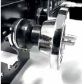
Abbildung 5 - Montage der Sichtkappe (optional)
