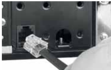
Abbildung 3 - Verbinden der Drehregler mit dem Radiogerät
